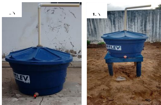
Figura 2. a) Dispositivos do biodecompositor. b) Estrutura de suporte com o biodecompositor instalado. (Fonte: os autores, 2015).
