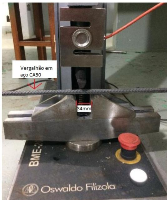
Figura 2. Ensaio de dobramento para o aço CA-50.
