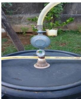
Figura 3. Válvula para medição do biogás.
