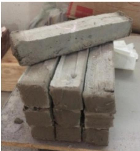
Figura 1. Corpos de prova de concreto com um vergalhão no meio de 5 x 5 x 250 cm.
