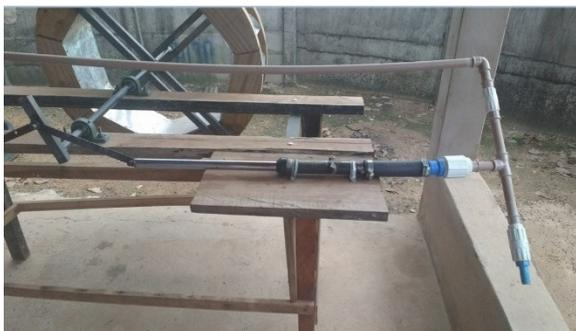
Figura 2. Sistema de funcionamento do virabrequim acionando o pistão (bengala) para se bombear água.
