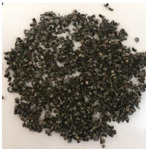
Figura 1. Cavaco de ferro fundido.
