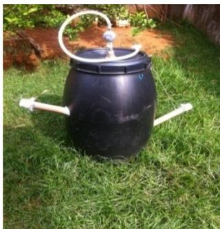
Figura 4. Protótipo do biodigestor.
