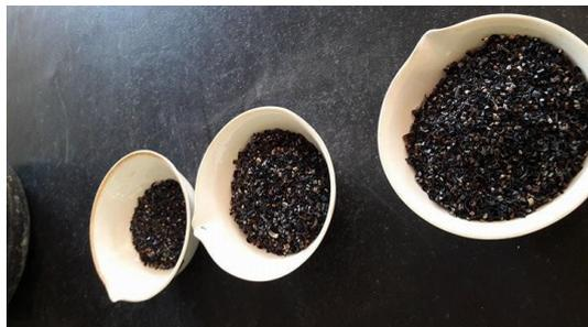
Figura 1. Cavaco de Usinagem de Aço.
