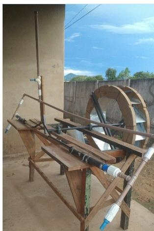
Figura 1. Disposição construtiva do sistema roda d'água e bomba volumétrica positiva; encaixe das paletas de zinco na madeira de sustentação da roda d'água.
