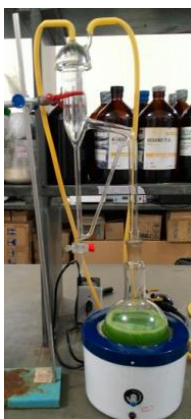
Figura 1: Montagem do aparelho de Clevenger para hidrodestilação.
